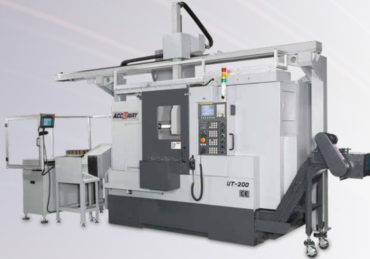
UT-200+ 門型機械手 + 治具板式工作料台
